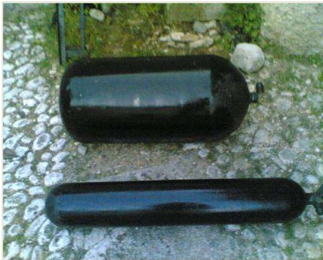
Serbatoi di metano compresso
