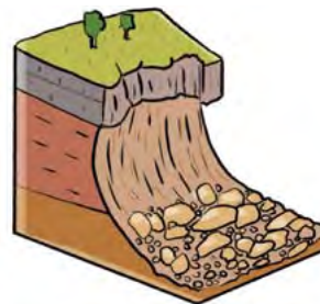
Frana di crollo
