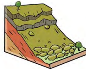
Frana di scivolamento
