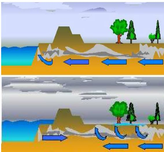
Questo non genera soltanto i fontanazzi in prossimità degli argini ma può creare buchi e anfratti nel sottosuolo e provocare cedimenti anche strutturali sia delle strade che delle case.
