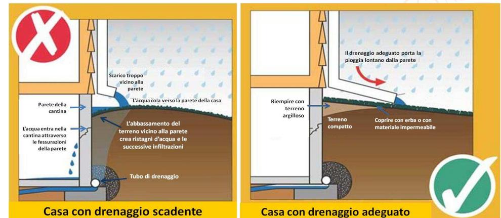
Il drenaggio perimetrale della casa riduce la pressione delle acque piovane o della falda freatica, che si alza durante le piene, convogliando l'acqua nel sistema fognario.
