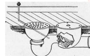
Come posizionare correttamente le valvole di non ritorno delle acque di fogna durante una alluvione per evitare l'allagamento di una cantina
