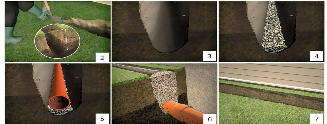
Nella costruzione di un sistema di drenaggio intorno alla casa, non utilizzare mai tubi corrugati e, ricordare, di inserire sempre il tessuto non tessuto per l'edilizia tra il terreno e il sistema drenante. Se non si osservano queste regole, dopo un po' di tempo, il tubo di drenaggio si intasa con la terra.
