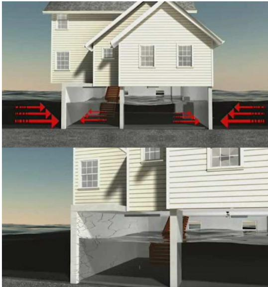
Se il livello dell'acqua per infiltrazione in una cantina è molto alto, significa che la falda freatica è saturata e la pressione sulle pareti dell'edificio è molto elevata. Rimuovendo l'acqua dai locali allagati, si rischia il collasso delle pareti dell'edificio.
