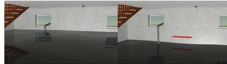
Se il nastro adesivo scompare, o l'acqua non diminuisce, significa che l'acqua sta ancora salendo. Non è ancora ora di iniziare le operazioni di svuotamento.
