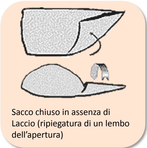
In assenza di lacci di chiusura i sacchi possono anche essere messi in modo che l'apertura venga inserita nel fondo del sacco precedente formando un corpo unico
