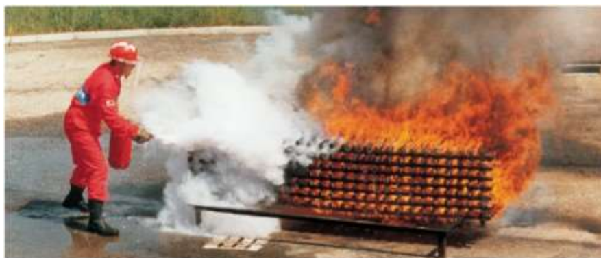
Fig. 2 - Vista laterale (varia secondo il focolare) Esempio di focolare tipo 13 A
